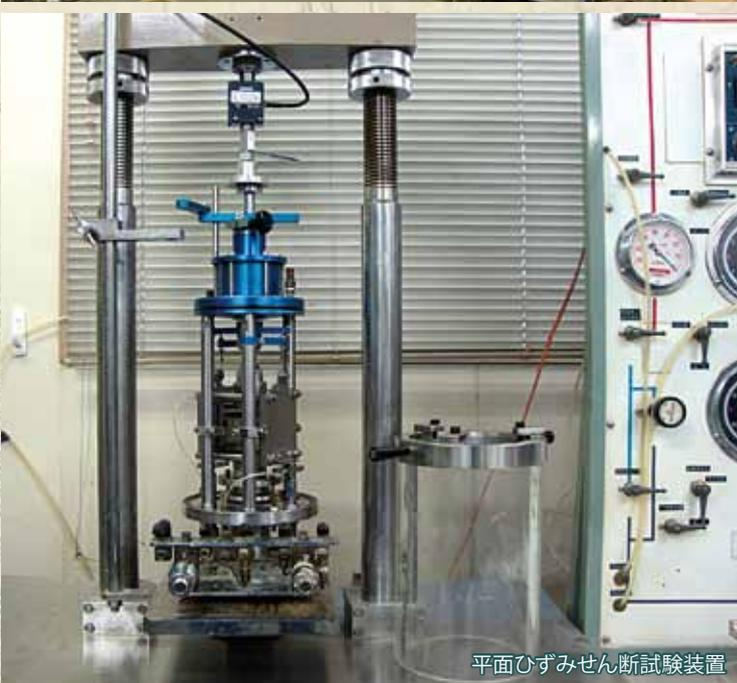
平面ひずみせん断試験装置
