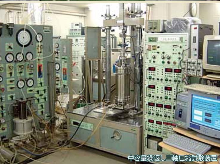
中容量繰返し三軸圧縮試験装置
